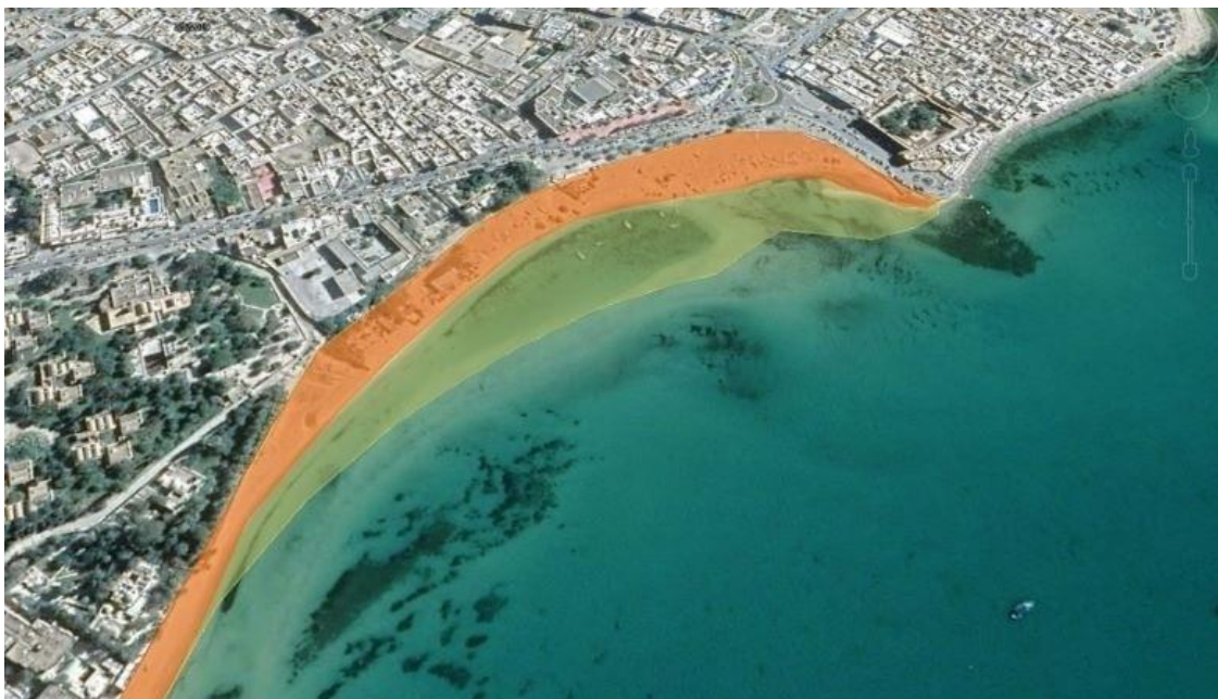
Figure 3: Érosion côtière sur la plage d'Hammamet en Tunisie. Note : En orange, la plage en 2019 ; en vert clair, sa superficie en 2006. Source: (Martin Philipp et al., 2021).
