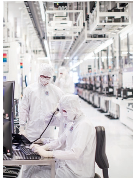
Mikrochip-Produktion bei Globalfoundries: Um die Partikelbelastung im Reinraum so gering wie möglich zu halten, tragen die Mitarbeiter in der Produktion spezielle Reinraumkleidung: einen Reinraumanzug, eine Kopfhaut, Handschuhe, Mundschutz und Schuhe.
